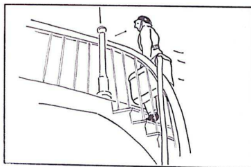
Bild 6. Slang skall läggas ut i ett trapphus med "öppen spindel".
